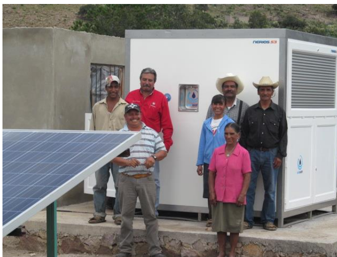
Equipo para generación de agua en humedad de zonas rurales desérticas (Zacatecas)
